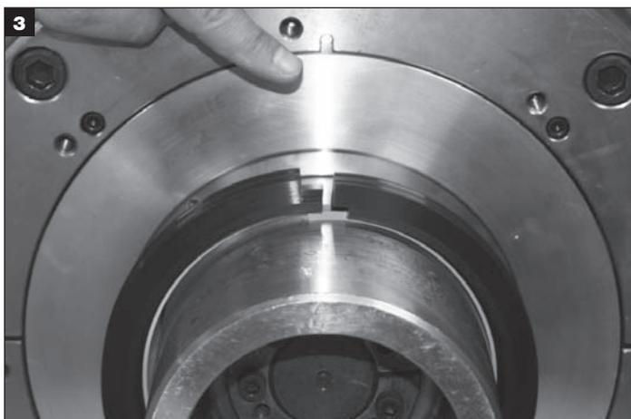
ツイストラップを外します。分割部の端をみつけて12時の位置で接合します。
