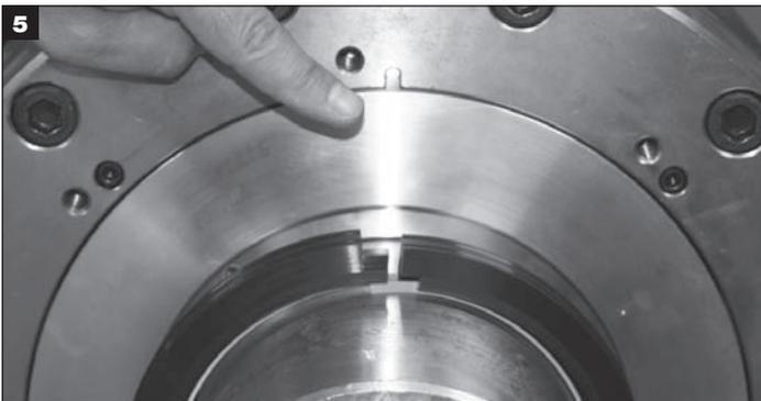
5 タイストラップを外します。分割部の端をみつけて12時の位置で接合します。
